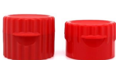
㊦従来のキャップ ㊦軽量化キャップ 軽量化キャップは凹凸部分を上部のみに残し、下部は滑らかにして薄肉化
